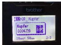
Mit den **Navigation Tasten** kann zwischen den beiden Vorlagen gewechselt werden und wird mit der **OK Taste** bestätigt.
