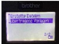
Mit den **Navigation Tasten** auf "übertragene Vorlagen" wechseln und mit der **OK Taste** bestätigen.
