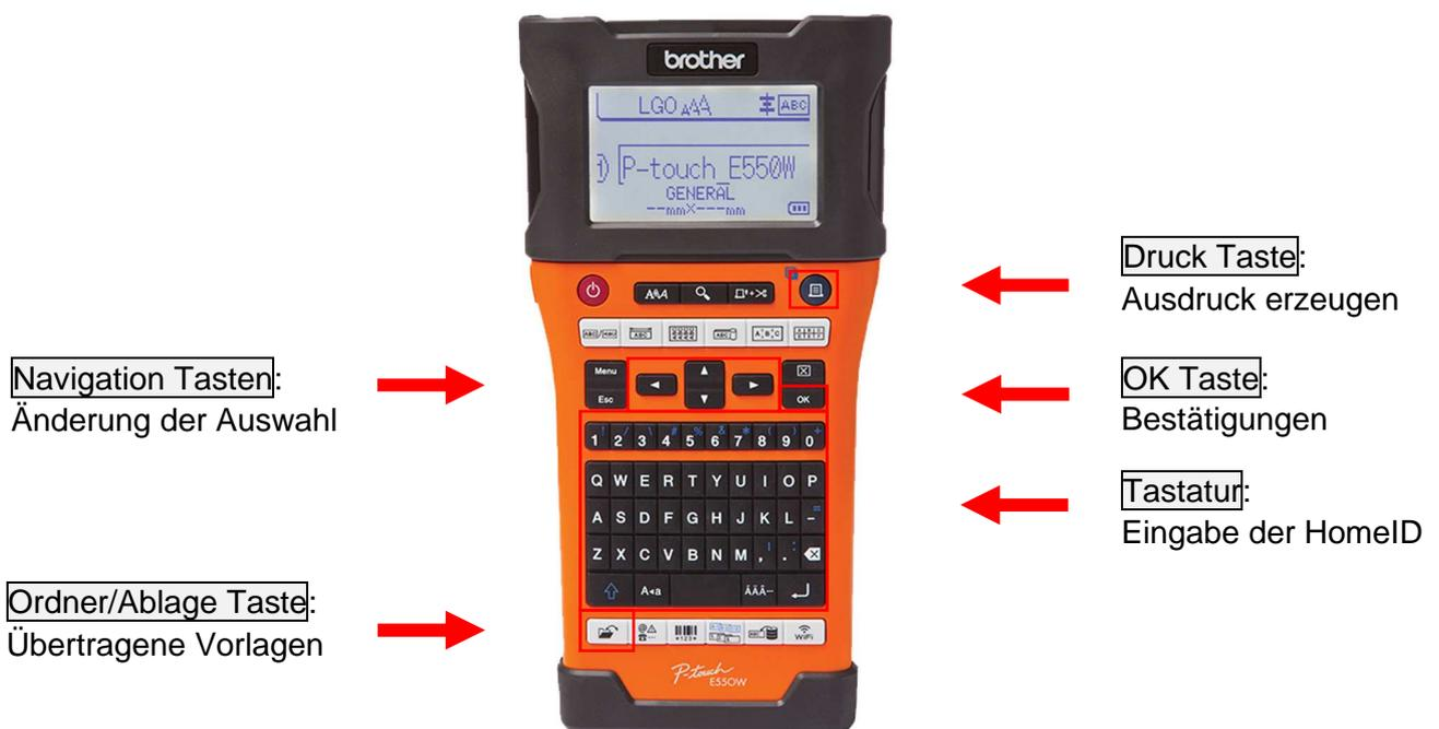
Zu den beiden Templates gelangt man über folgende Bedienung am Gerät:
